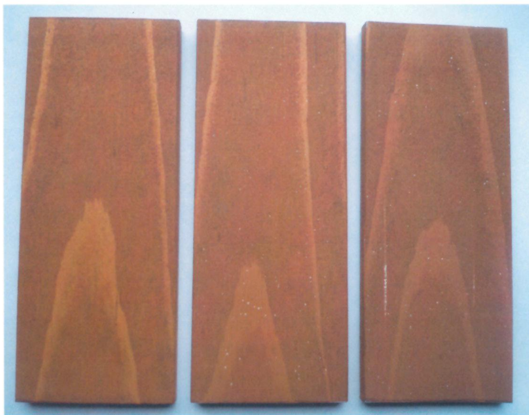
Рис. 1 Состояние поверхности образцов: а–исходный, б -после 15 циклов, в – после 30 циклов.
