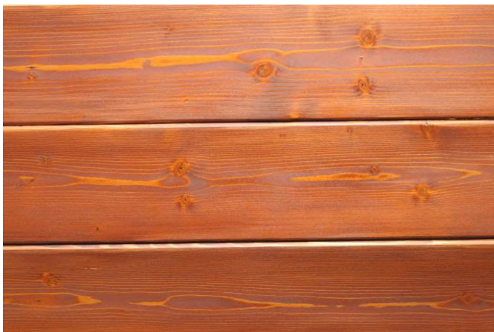
Готовое покрытие Pullex Plus Lasur (2-х слойное нанесение)
